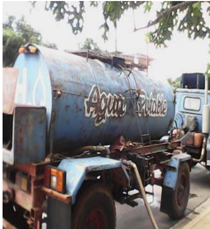
Carretas Cisternas tiradas por tractores para la distribución de agua en el pueblo
